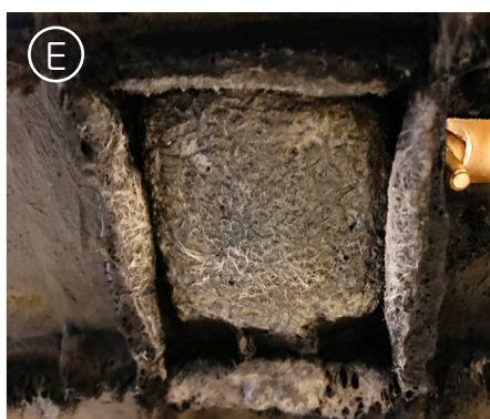
图 D 显示了耐火测试结束后的测试后板材图片
